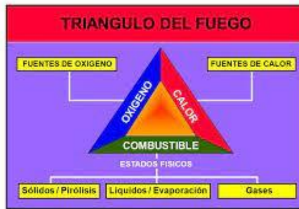
Figura N°2: Triángulo del fuego
