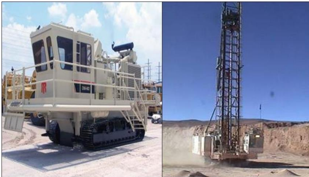
FIGURA 1.7 PERFORADORA DIESEL DMM 2 Y PERFORADORA ELÉCTRICA 49R III
