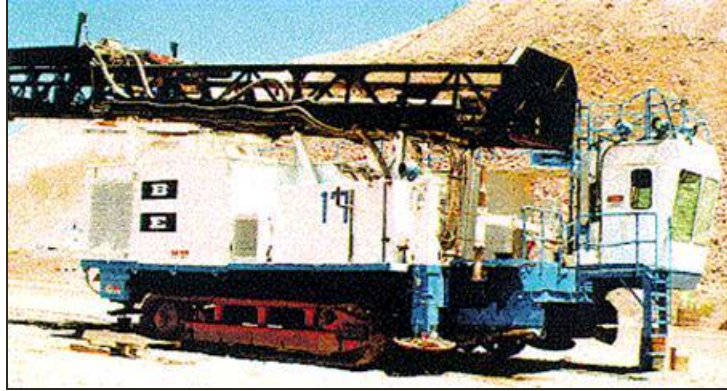
FIGURA 1.3 ARTICULA PARA COMPENSAR LOS DESNIVELES DEL TERRENO
