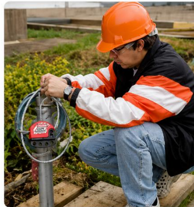
APLICACIÓN EN CAMPO Se utiliza para bloquear válvulas, manijas u otros puntos de energía donde no es posible usar candados convencionales.
